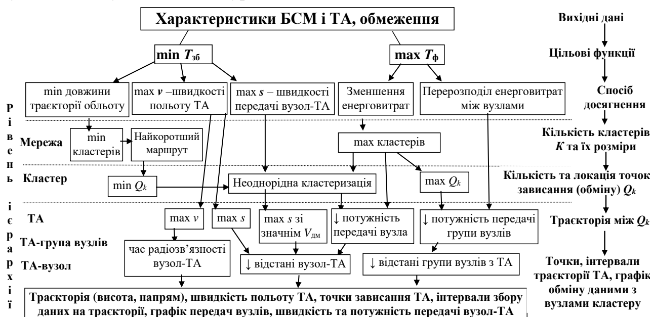
Рис. 2. Схема визначення траєкторії польоту ТА для збору даних з вузлів БСМ.
