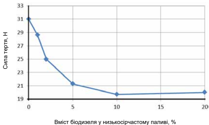
Рис. 5. Вплив вмісту метилових ефірів пальмової олії в суміші низькосірчастого палива на силу тертя
