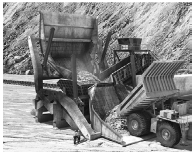
Рис. 3. Конструкція перевантажувального пункту (FLSmidth [11])
