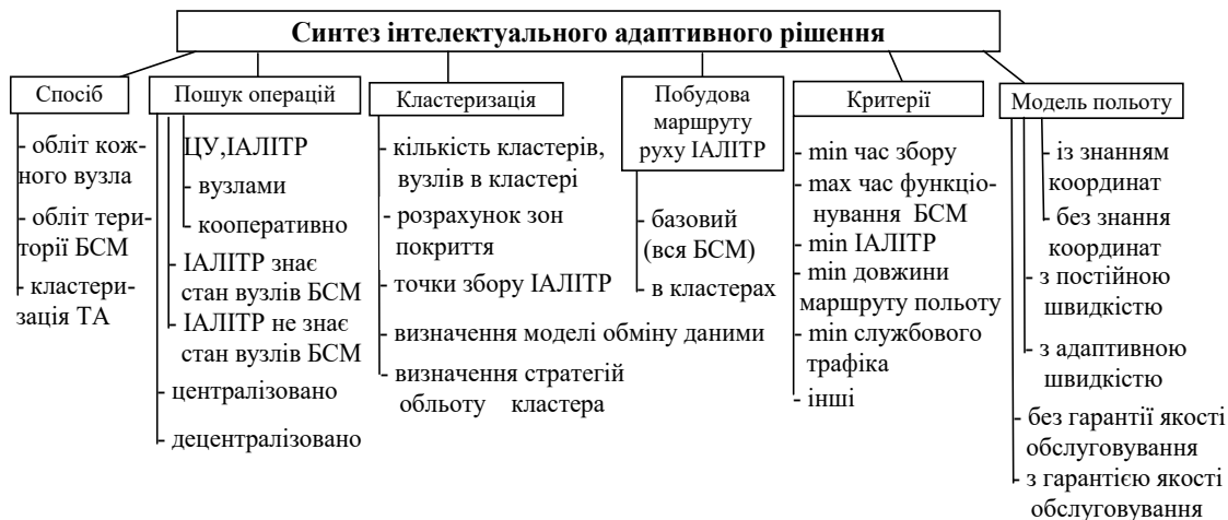
Рис. 1. Структура системного підходу стосовно вибору раціонального способу збору інформації з вузлів БСМ
