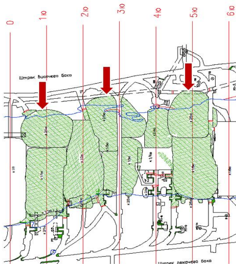
Рис. 1. Порушення контуру деяких очисних камер у формі обвалення порід висячого боку (дільниця покладу від 0 до 6ю)
