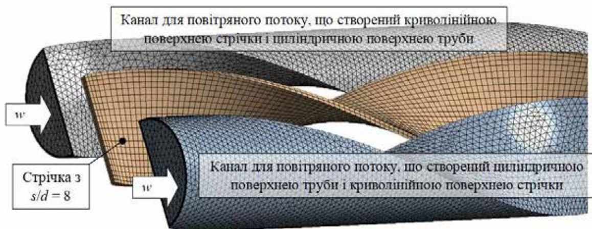
Рис. 1. Скінченно-елементна сітка моделі з s/d = 8 з d = 18 мм
