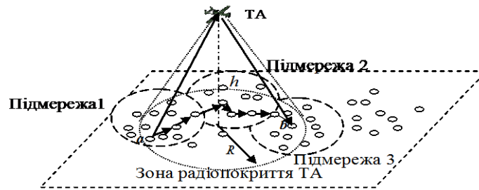
Рис. 6. Приклад застосування правила для зменшення довжини маршруту передачі даних
