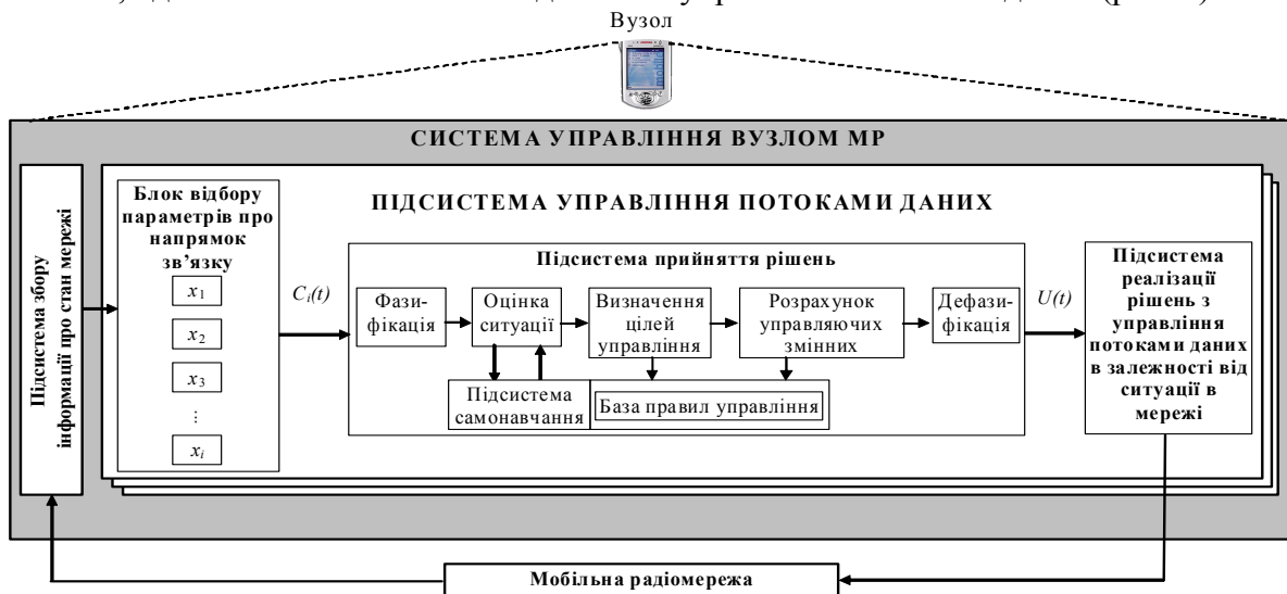
Рис. 1. Схема підсистеми управління потоками даних в МР
