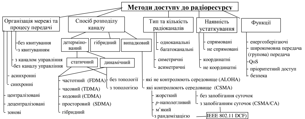
Рис. 9. Класифікація методів доступу до радіоресурсу
