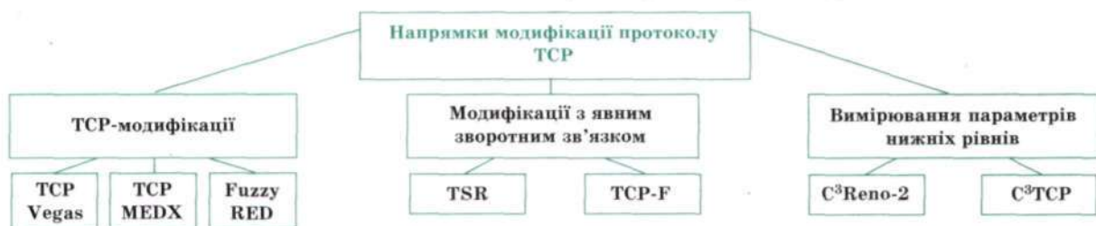
Рис. 4. Напрямки модифікації протоколу TCP для мереж MANET
