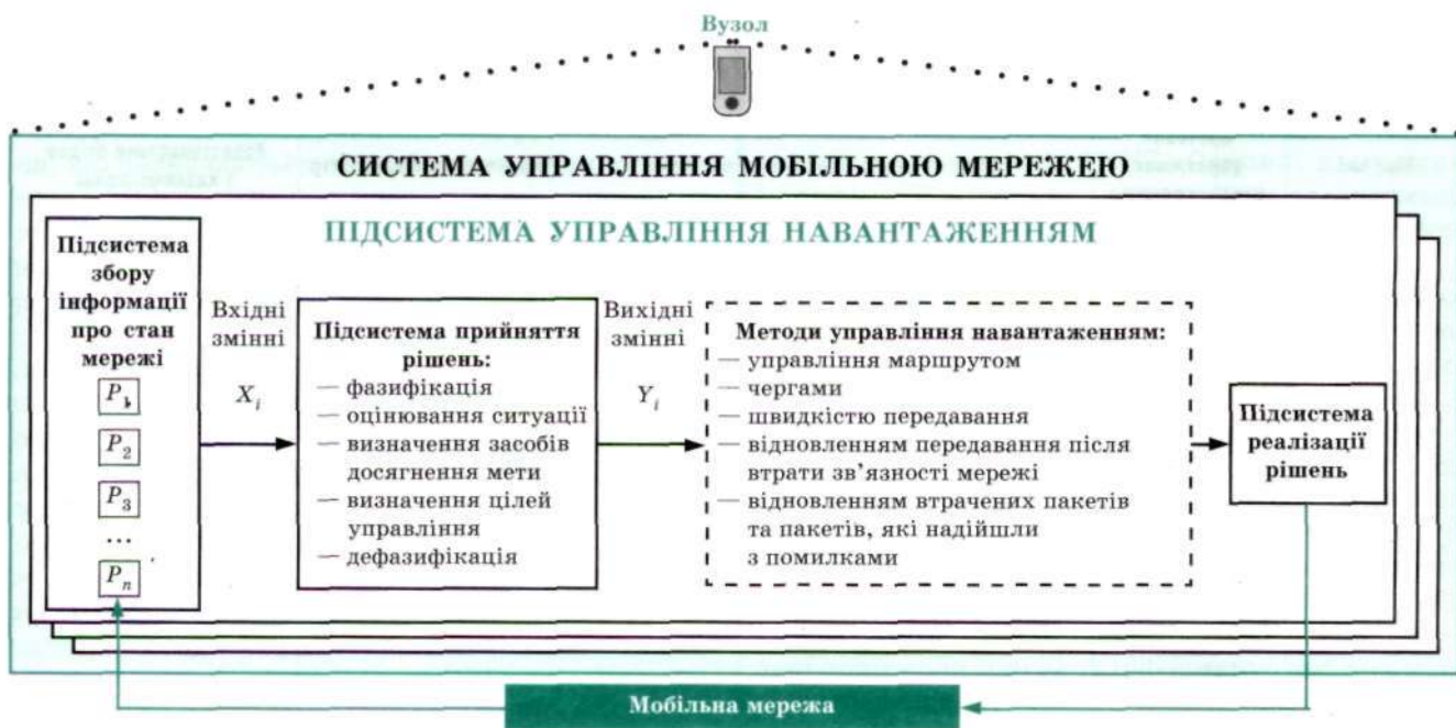
Рис. 2. Схема підсистеми управління навантаженням у складі системи управління мережею
