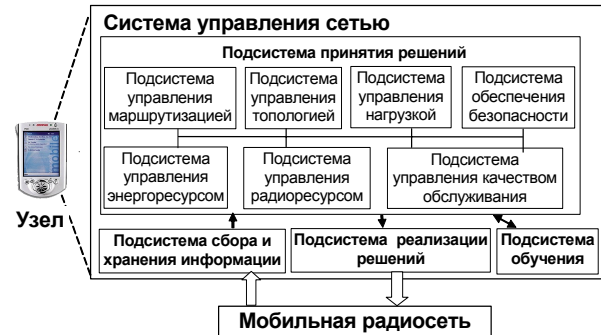
Рис. 1. Функциональная модель системы оперативного управления мобильной радиосетью.
