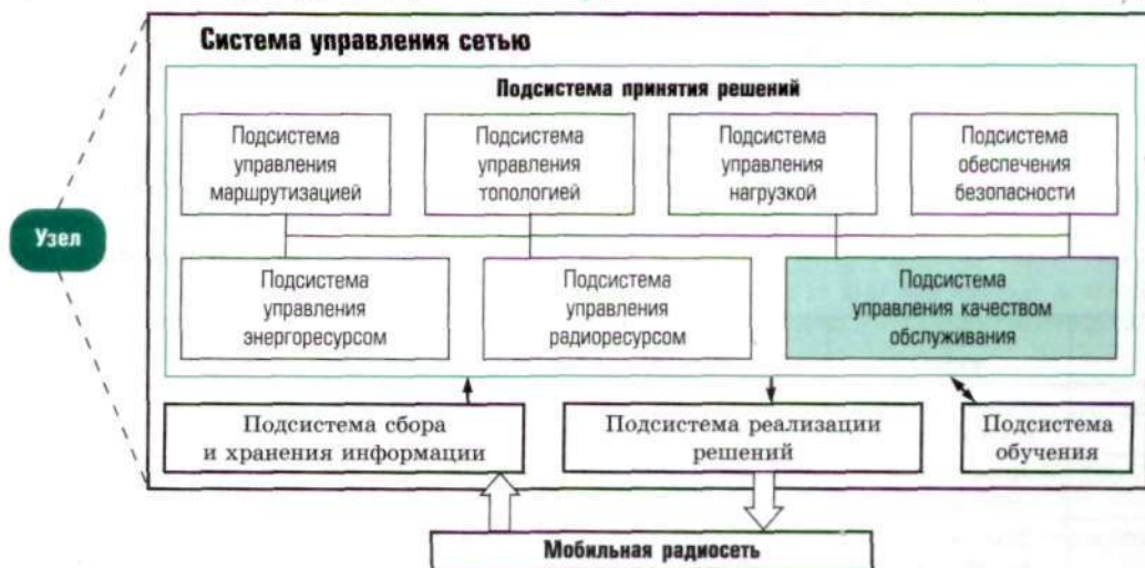
Рис. 1. Функциональная модель системы оперативного управления мобильной радиосетью
