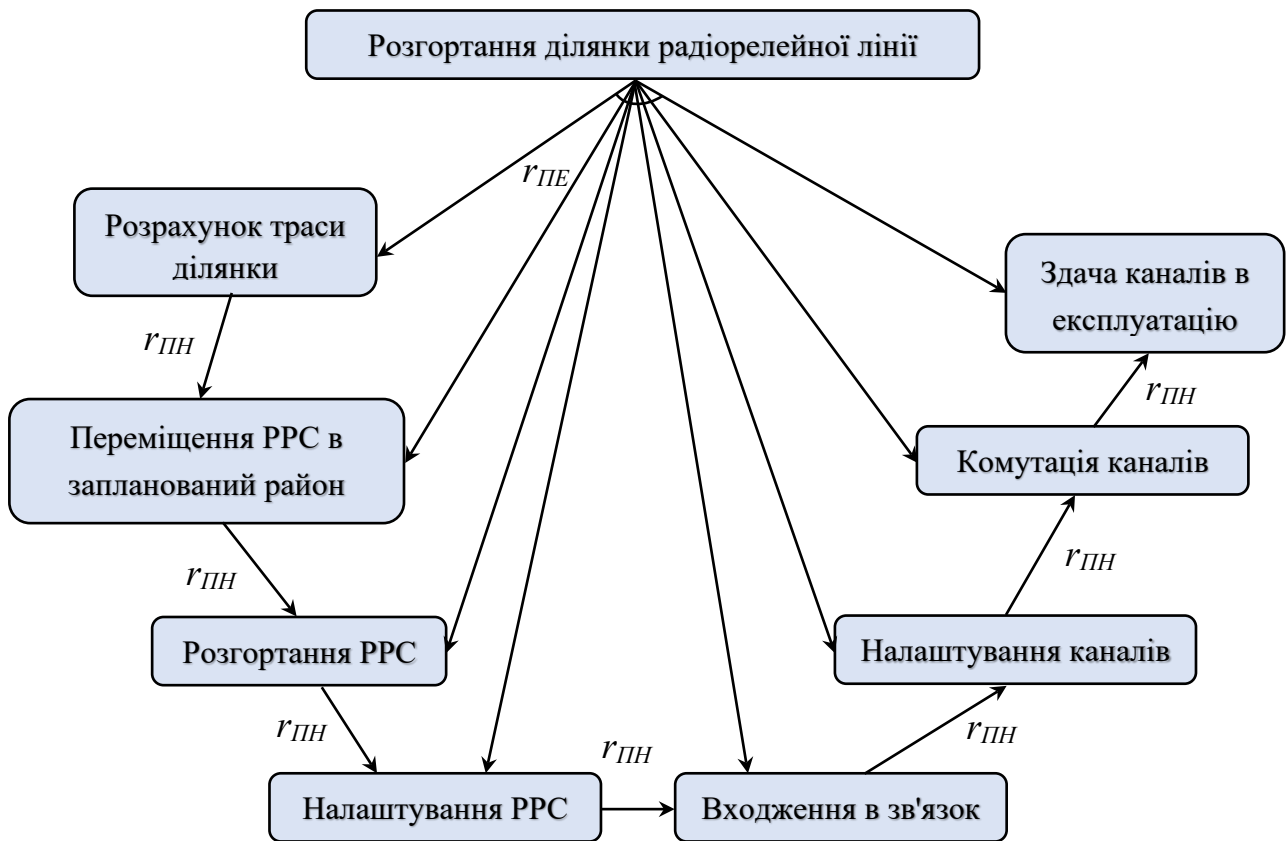
Рис. 2. Відношення між процесами на прикладі процесу розгортання ділянки радіорелейної лінії (РРС – радіорелейна станція)
