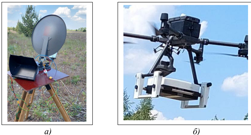
Рис. 4. Загальний вигляд макетного зразка радіолінії ММ-діапазону: а – бортовий сегмент; б – наземний сегмент
