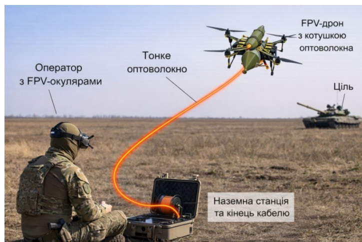
Рис. 2. Управління FPV-дроном на основі оптоволоконного методу
