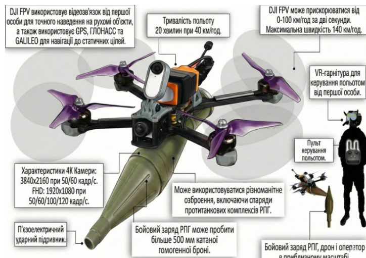
Рис. 1. Основні компоненти управління FPV-дроном
