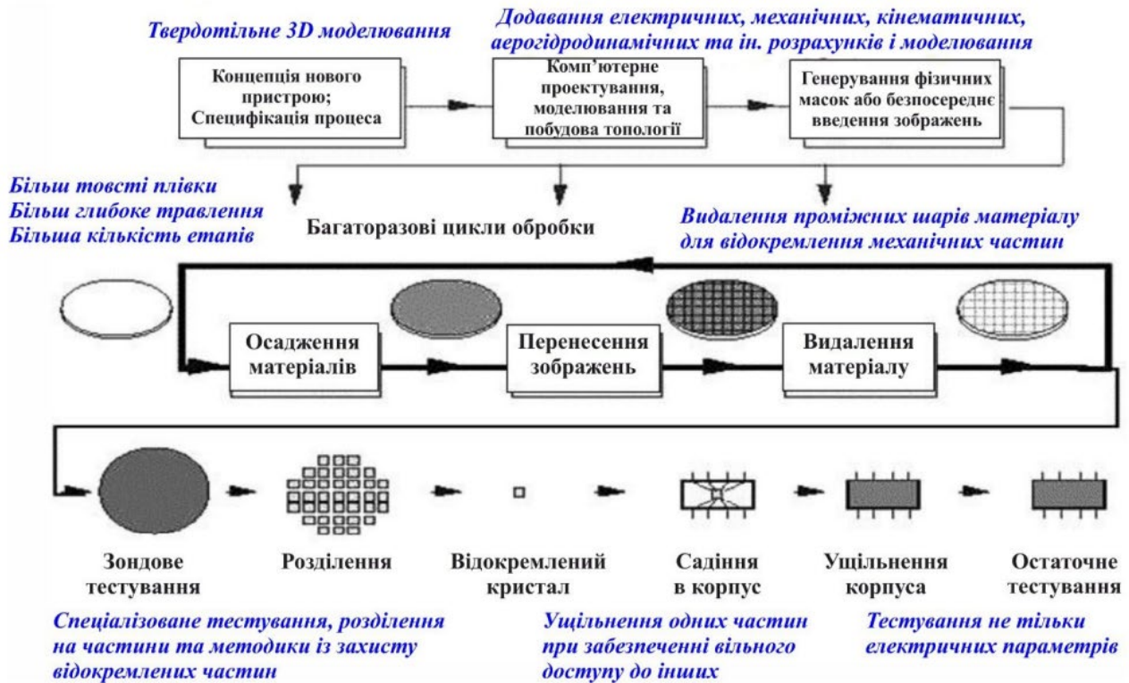
Рис. 3. Подібність і відмінність процесів розробки й виготовлення кремнієвих мікрочипів і виробів мікроелектроніки
