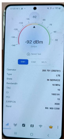
Рис. 6. Скриншот індикаторної панелі смартфона Samsung S21 при наявності впливу засобу РЕБ
