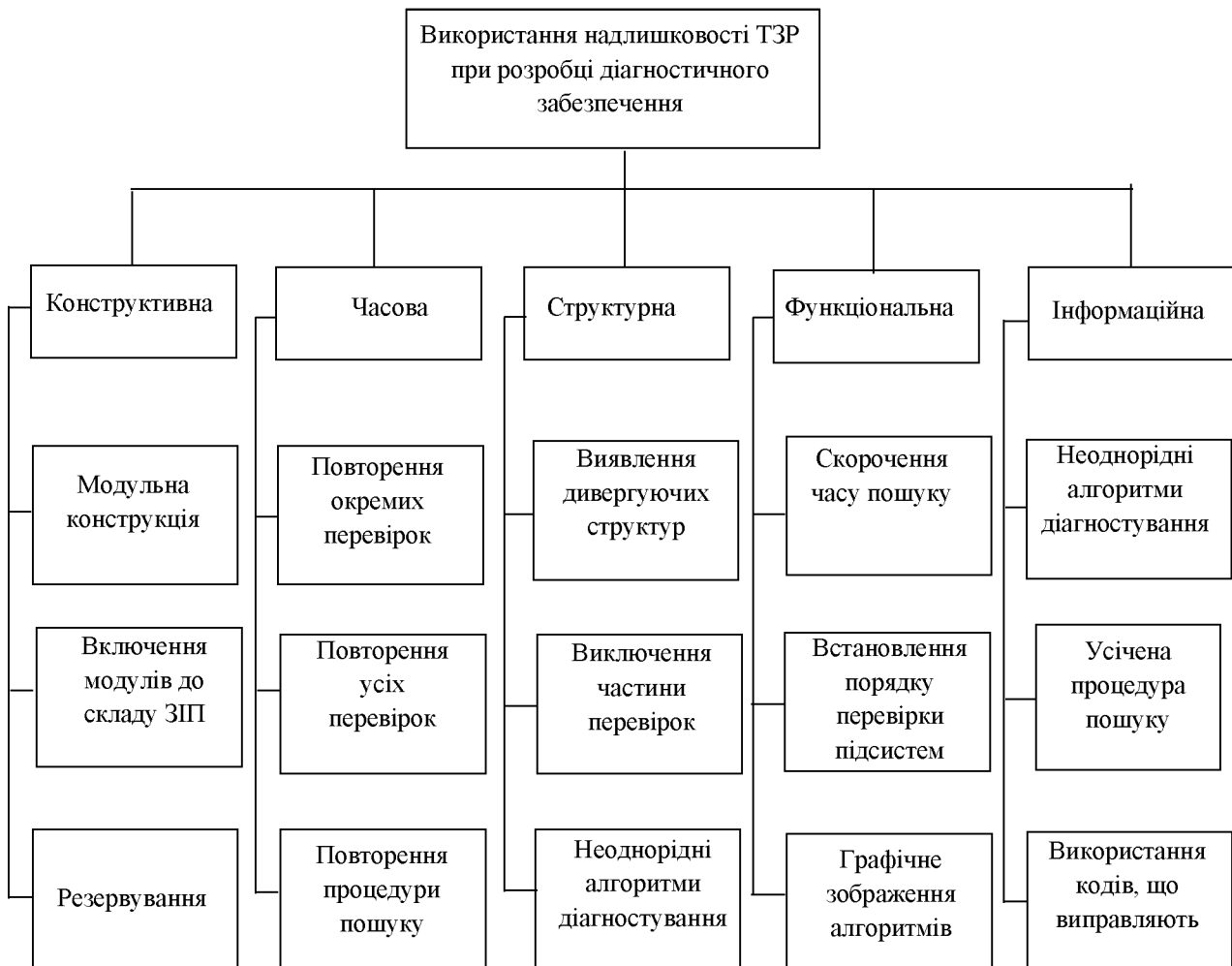
Рис. 2. Використання видів надлишковості ТЗР для підвищення достовірності результатів їхнього діагностування
