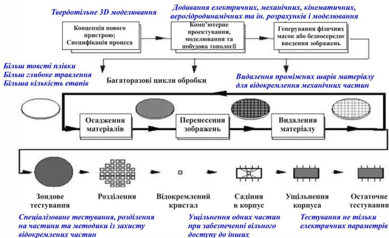
Рис. 3. Подібність і відмінність процесів розробки й виготовлення кремнієвих мікросипів і виробів мікроелектроніки
