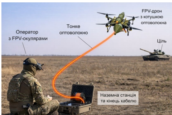
Рис. 2. Управління FPV-дронем на основі оптоволоконного методу
