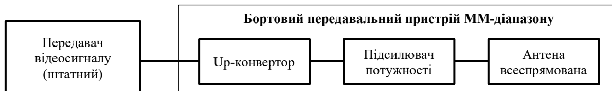
Рис. 2. Структурна схема бортового аналогового передавального пристрою інформаційної радіолінії БпЛА
