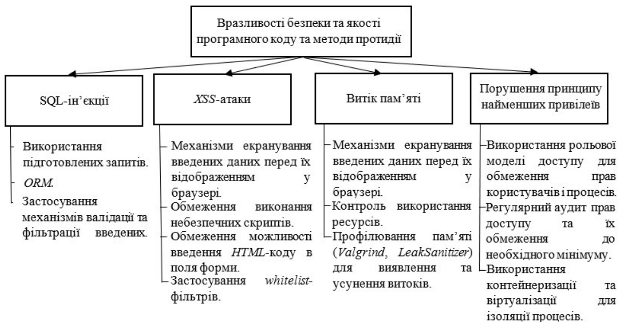
Рис. 1. Основні вразливості безпеки та якості програмного коду та методи їхнього запобігання
