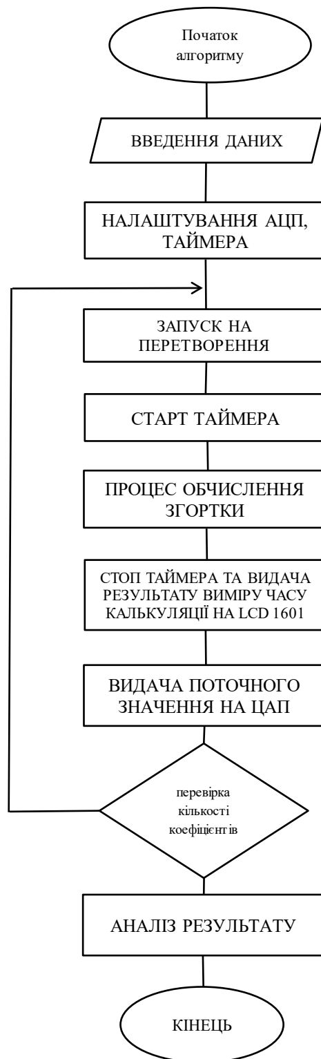
Рис. 2. Блок-схема алгоритму виміру часу калькуляції згортки
