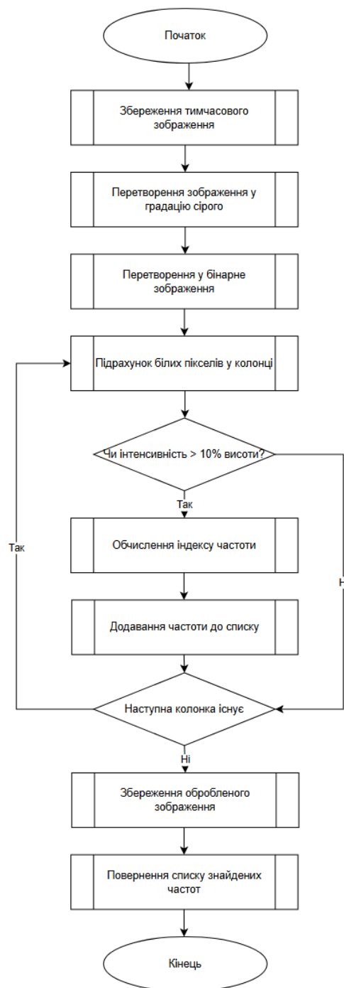
Рис. 1. Алгоритм відокремлення шумів у спектрограмі від реальних даних за допомогою порогової бінаризації
