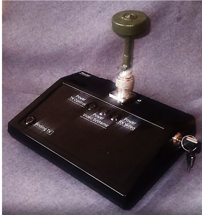
Рис. 4. Зовнішній вигляд симулятора керування роботом з FPV та каналом зворотного зв'язку
