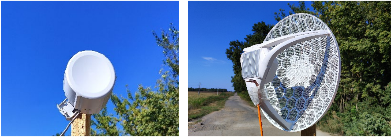
Рис. 2. Зовнішній вигляд додаткового обладнання типу Mikrotik SXT LTE6 kit (ліворуч), Mikrotik LHGG LTE6 kit (праворуч)
