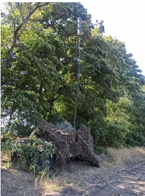
Рис. 4. Зовнішній вигляд (варіант) рухомої базової станції мережі LTE
