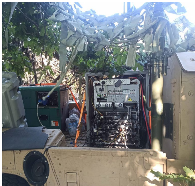
Рис. 4. Зовнішній вигляд (варіант) рухомої базової станції мережі LTE
