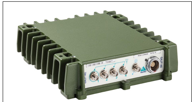
Рис. 9. CRPA-пристрій GALT-AE-N компанії Hexagon Novatel, Канада
