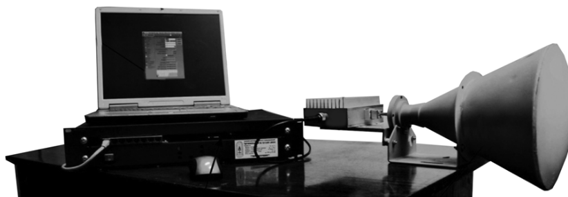
Рис. 2. Зовнішній вигляд лабораторного зразка цифрової симплексної радіорелейної системи терагерцового діапазону
