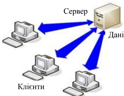
Рис. 2. “Товстий клієнт” – робоча станція або ПК, що працює під управлінням власної дискової ОС і має необхідний набір ПЗ
