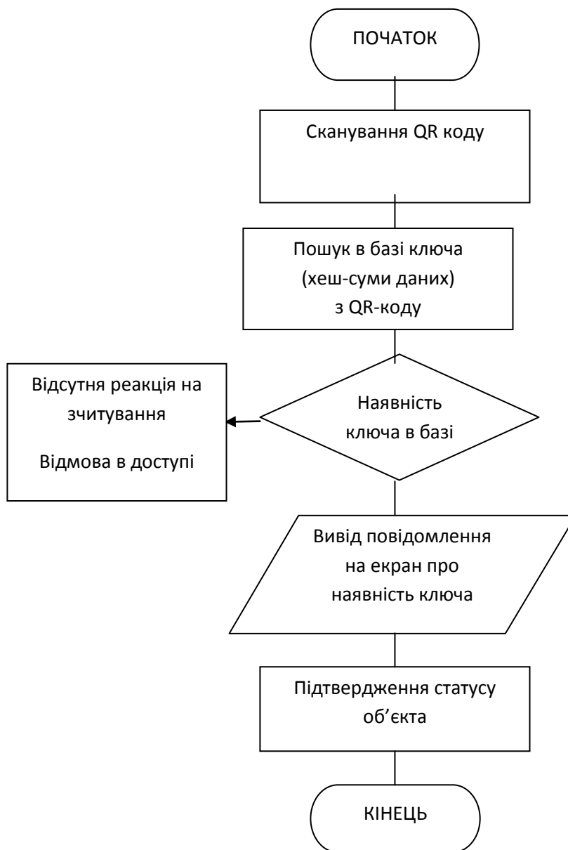
Рис. 7. Блок-схема алгоритму роботи додатку faceScanQr
