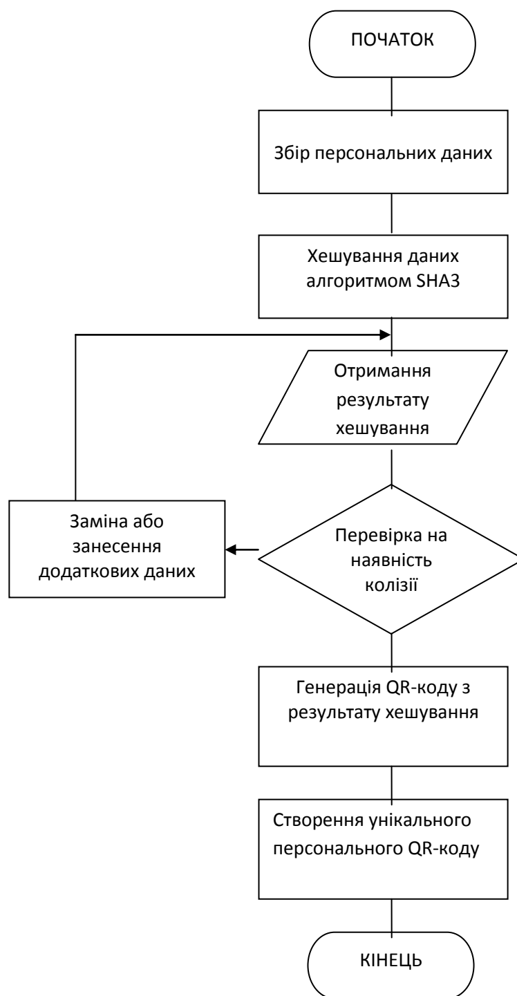
Рис. 3. Блок-схема алгоритму ідентифікації та створення персонального QR-коду
